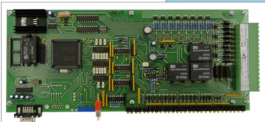
Die Steuerlogik ist grundsätzlich frei programmierbar, wird in der Anwendung jedoch zumeist mit der im EPROM vorhandenen Software der Originalsteuerung betrieben.
