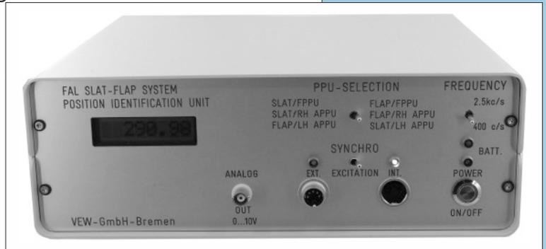
Die interne Erregerspannung ist umschaltbar zwischen 400 Hz und 2,5kHz. Die Ausgangsspannung beträgt 26V RMS.
