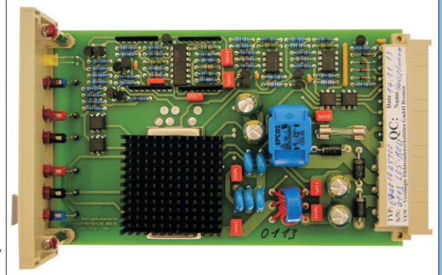
Der Arbeitsbereich der verwendeten DC/DC-Wandler Module reicht von 16V bis 36V und ist zusätzlich mit einem aktiven Transientenschutz ausgerüstet, der die spezifizierten Überspannungen (für 20mS) des 2-fachen der nominalen Eingangsspannung bis 48V sicher eliminiert, sowie Transienten bis 1000V//50µs.
